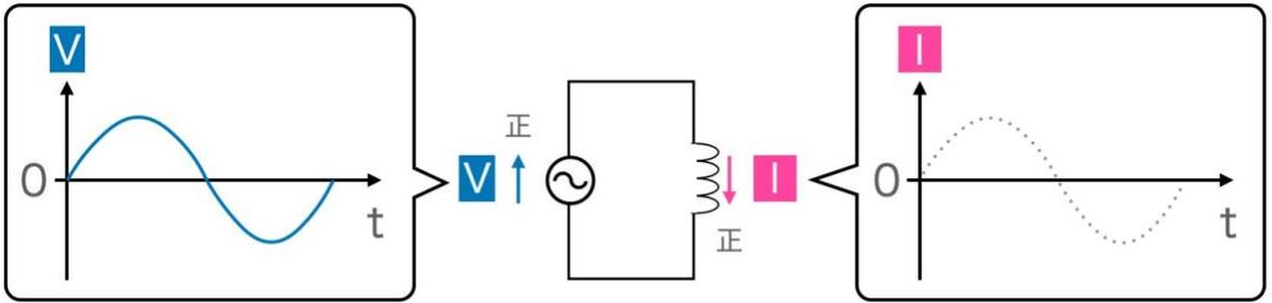
抵抗の代わりにコイルをつけると、コイルには常に（ ）が起こり、電圧とは逆向きの起電力が起こります。電源電圧は  $V = V_0 \sin \omega t$  とします。
