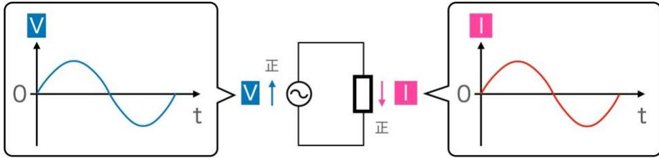
電源電圧  $V$  と流れる電流の  $I$  の位相のずれは  $(\quad)$  です。つまり電源から電場が抵抗にはたらくと同時に、電流が流れます。しかしコイルやコンデンサーはその様子が異なります。
