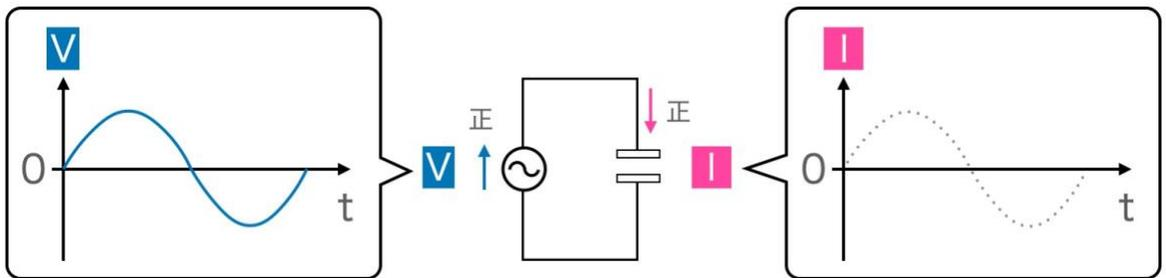
抵抗の代わりにコンデンサーをつけると、直流電源とは異なり電圧の向きが変化するため回路には電流が流れ続けます。このときに回路に流れる電流を数式で表してみよう。電源電圧は  $V = V_0 \sin \omega t$  とします。回路に流れる電流は  $I = \frac{dQ}{dt}$  であり、またコンデンサーの式  $Q = CV$  より、
