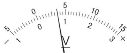
ある電圧計について「測ることができる電圧」を大きくしたい場合、別の抵抗を内部抵抗に対して（ ）でつなぎます。例えば 3V までしか測れない電圧計を 15V まで測ることができる電圧計にしたければ、電圧計に 15V の電圧がかかったときに、（ ）V と（ ）V にわかれるようにして、電圧計の最大の表示を 15V に変えます。この抵抗（器）を（ ）といいます。
