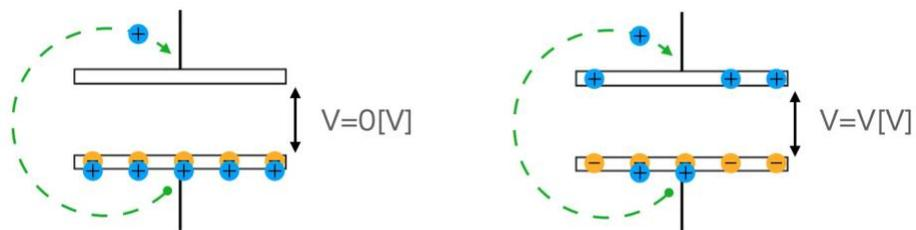
このとき  $V-Q$  図では、外力のした仕事は小さな帯の面積と一致します。この  $\Delta Q$  を限りなく小さくしてから、 $0$  から  $+Q$  まで面積を足し合わせていくと、 $V-Q$  図の三角形の面積にあたります。
